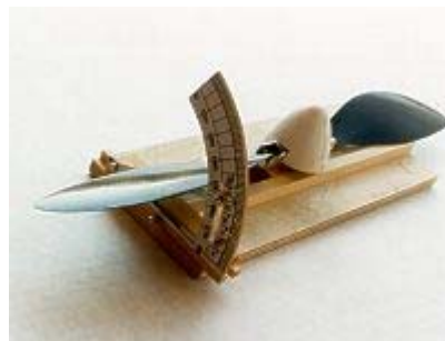
Abb 3: Steigungswinkelmessgerät aus eigener Werkstatt. Verstellbar für kleinste bis sehr große Luftschauben.
