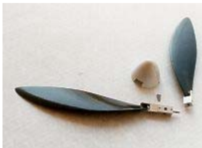
Abb 2: Verstellbares Luftschaubenmittelstück Patent Czepa. Feinmechanikarbeit Peter Dolezal, Wien.
