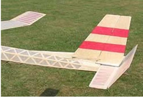
(0,65%  $\eta$ ) = 29,6 W, Steigfluggeschwindigkeit = 6,03 m/s. Daraus theoretische Gesamtflugzeit aus 19 Steigflügen mit je 41 s Motorlauf: **3 h und 29 min.**
